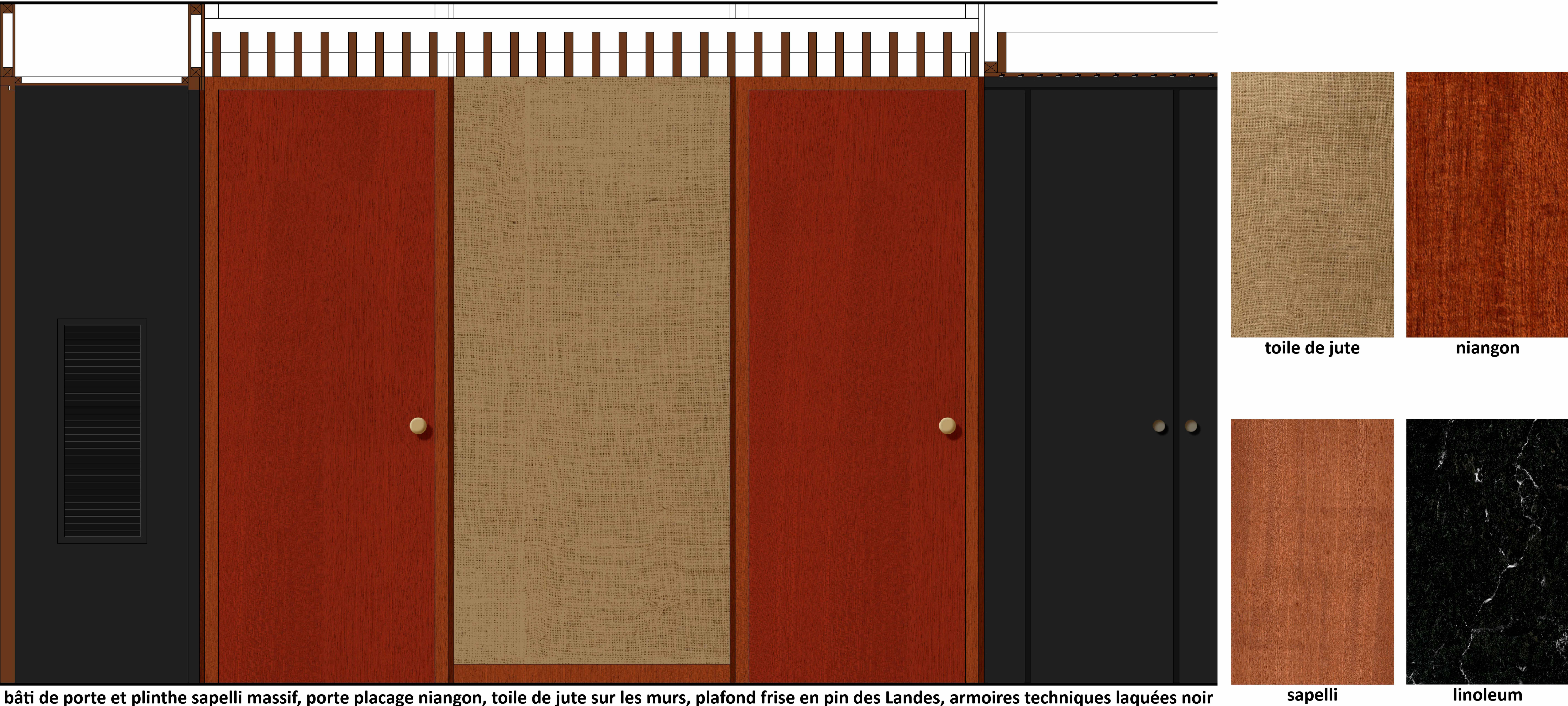
bâti de porte et plinthe sapelli massif, porte placage niangon, toile de jute sur les murs, plafond frise en pin des Landes, armoires techniques laquées noir
